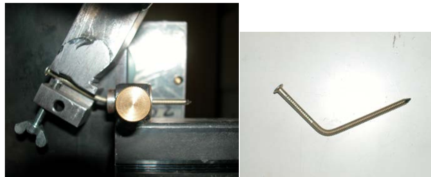
Испытание предельного момента в соответствии с EN 409
